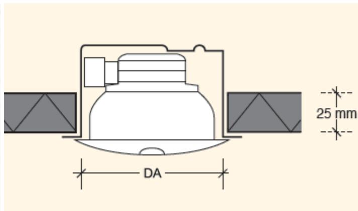
Точно центрируйте светильник в отверстии. Светильники с высоким весом необходимо крепить отдельным подвесом к потолочному перекрытию. **Максимальная допустимая температура для плит Heradesign  $\leq 60^{\circ}\text{C}$**
