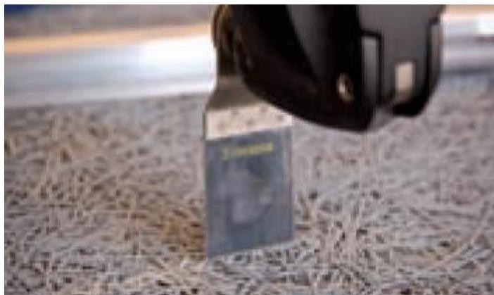
**Supercutter:** устанавливайте лезвие строго перпендикулярно поверхности плиты
