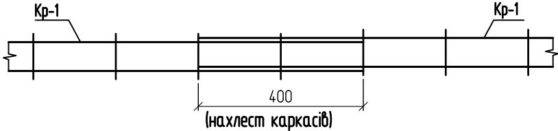
Вузол стикування каркаса Кр-1
