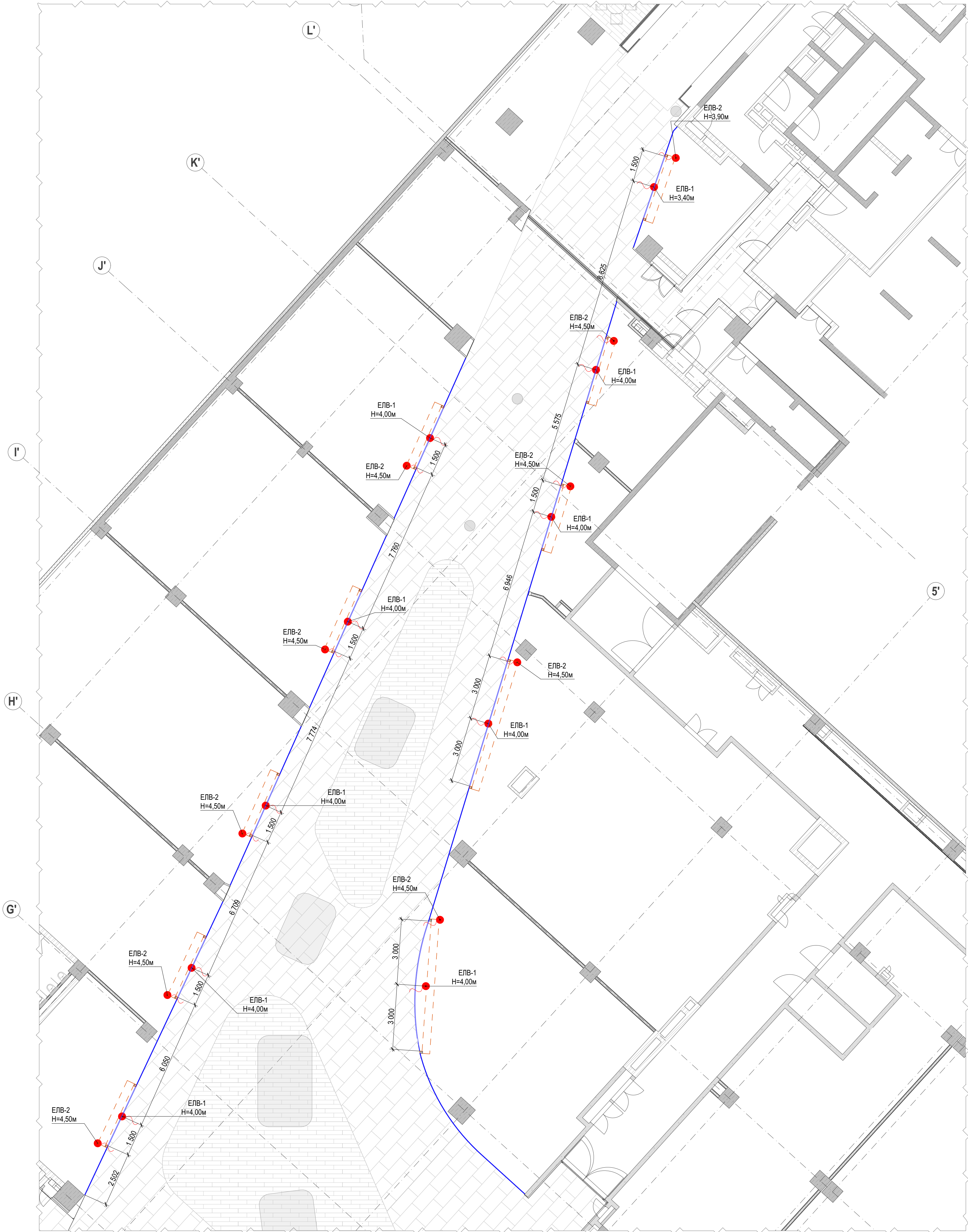
Фрагмент 2.План розміщення електровиводів поверху L02 відм.+6,150
