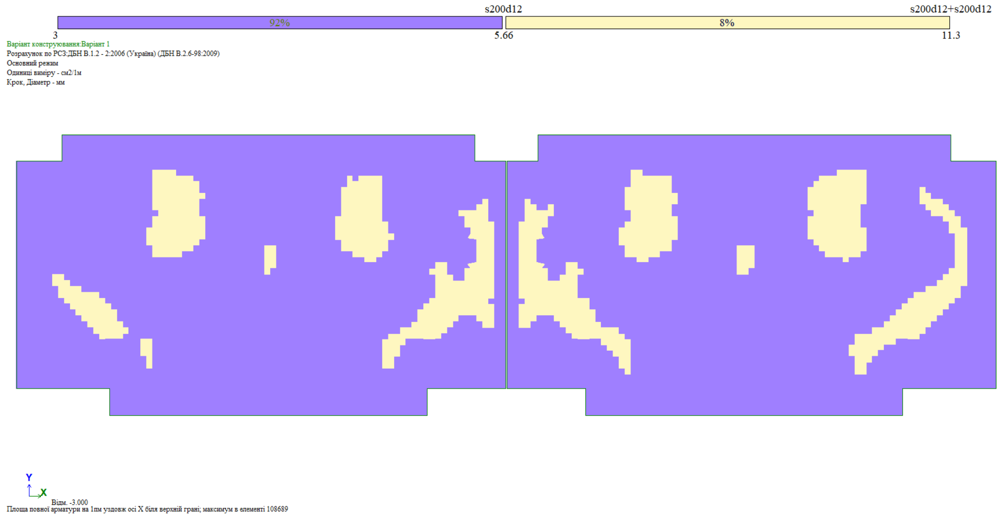
Рис. Б.13 – Армуння верхньої зони вздовж осі X (см 2 /1м) фундаментної плити
