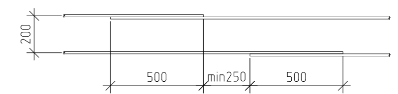
Схема стикування арматури (поз. 1)
