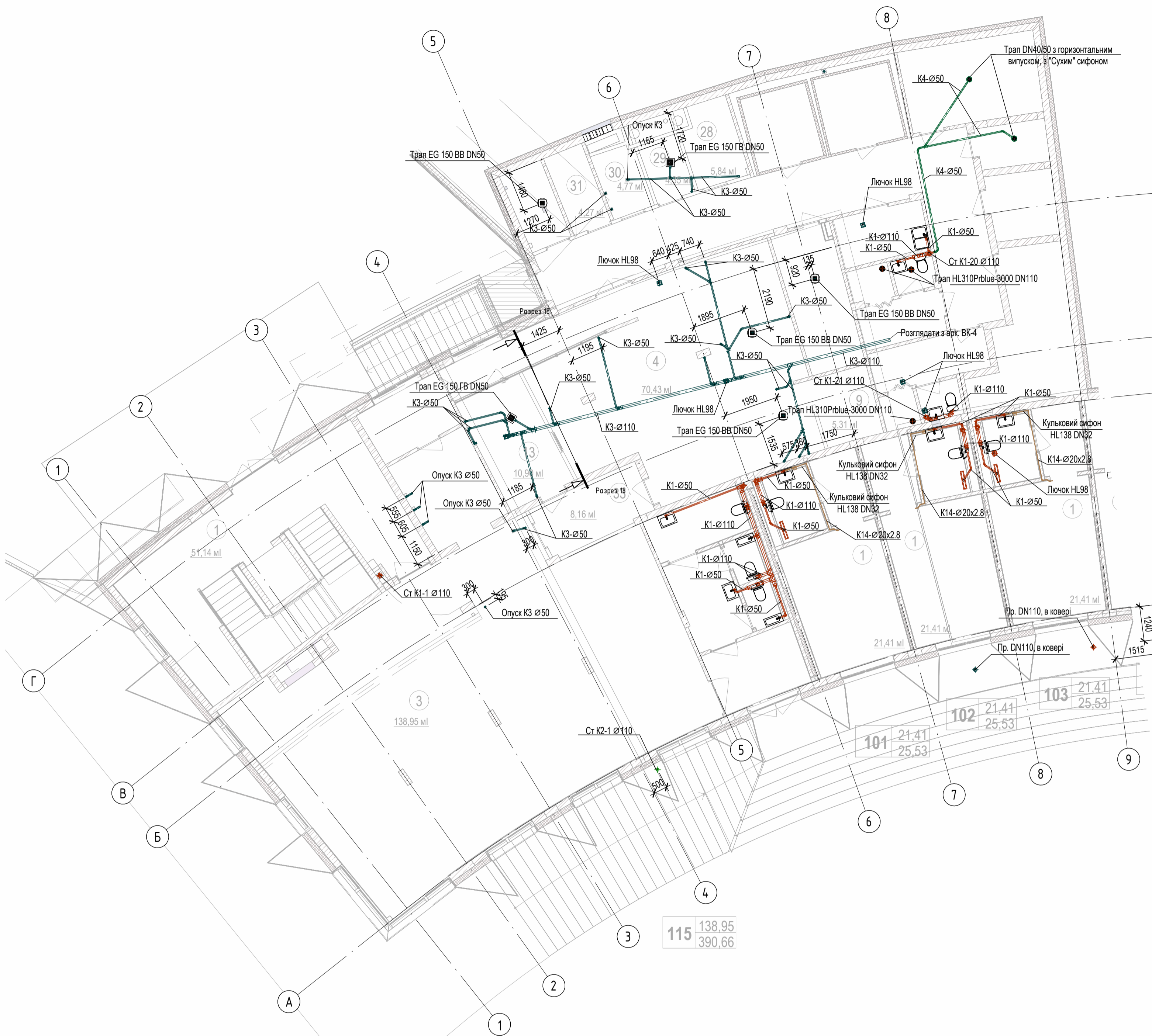
План мереж K1, K2, K3, K14 на відмітці 0.000 (вісь 1-9). M1:100
