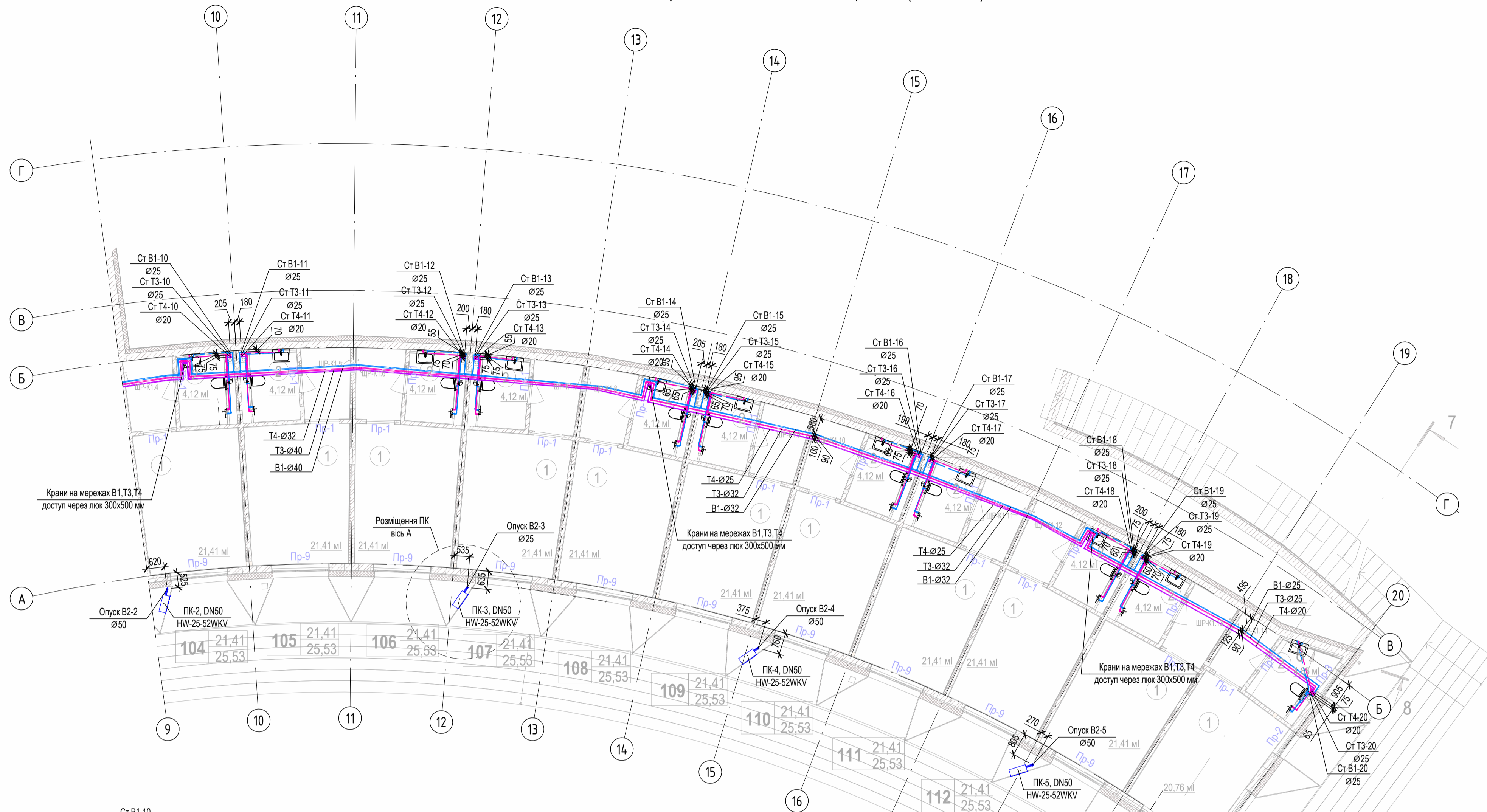
Схема магістральних мереж В1,Т3,Т4 на відмітці 0.000 (під стелею 1-ого поверху).
