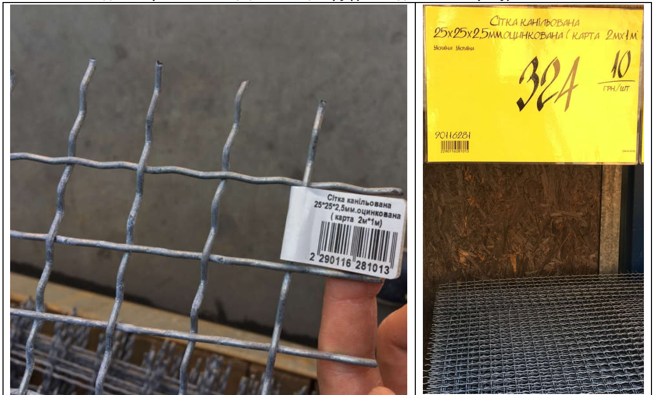
Вигляд металевої сітки згідно ГОСТ 3306-88
