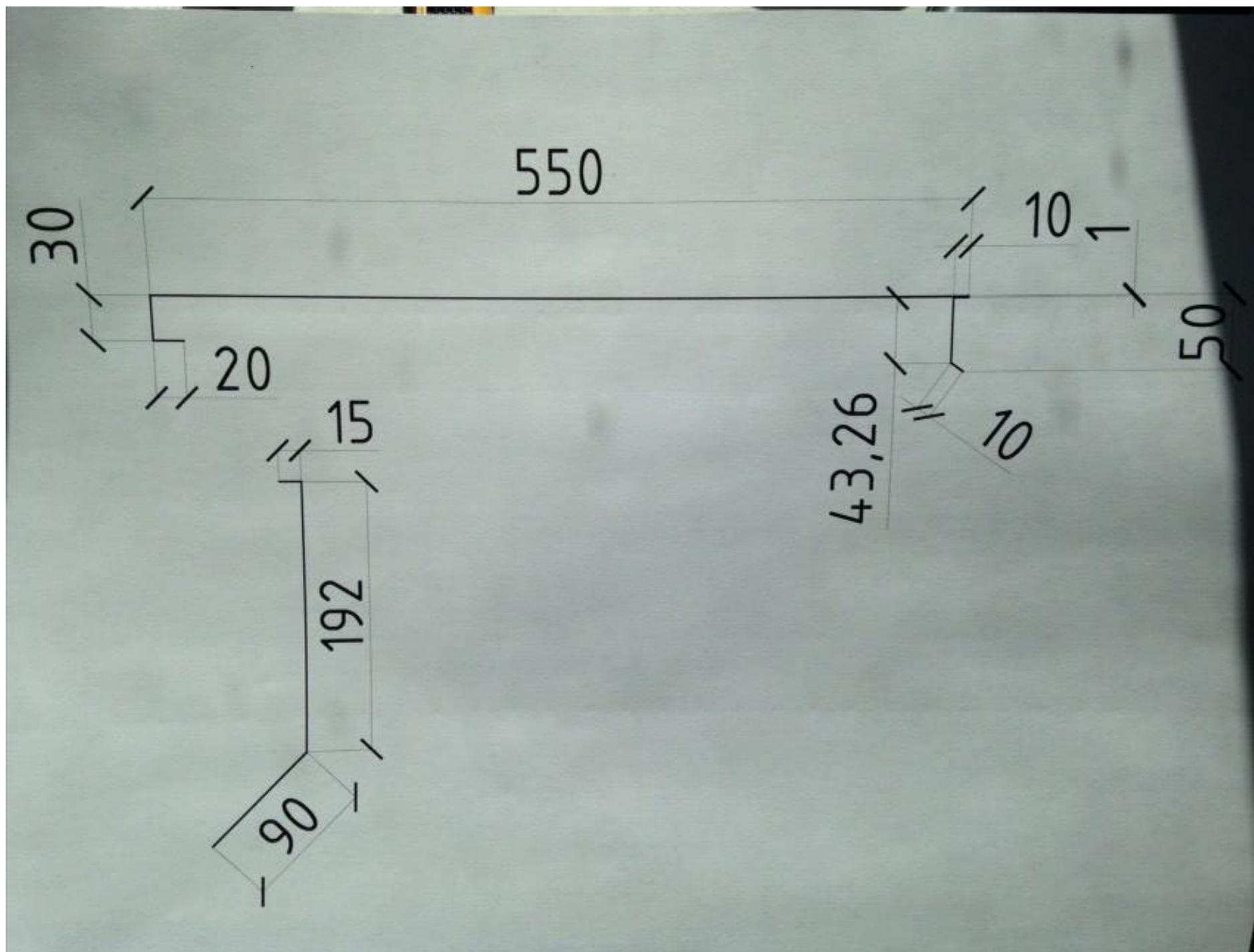
ФРОНТОН рис.2. Отливы – 28м.п. (отделка водостойкой фанерой, затем обшивка металлом)
