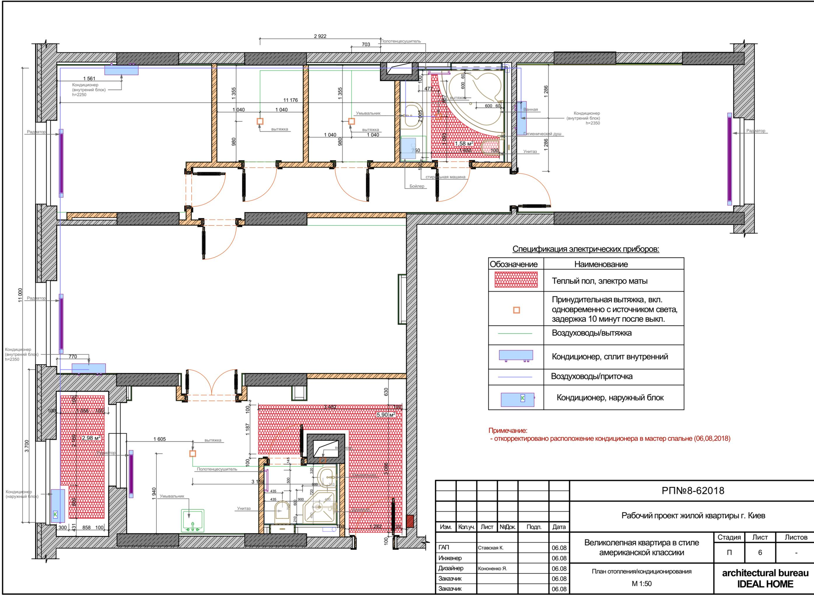
Спецификация электрических приборов:
