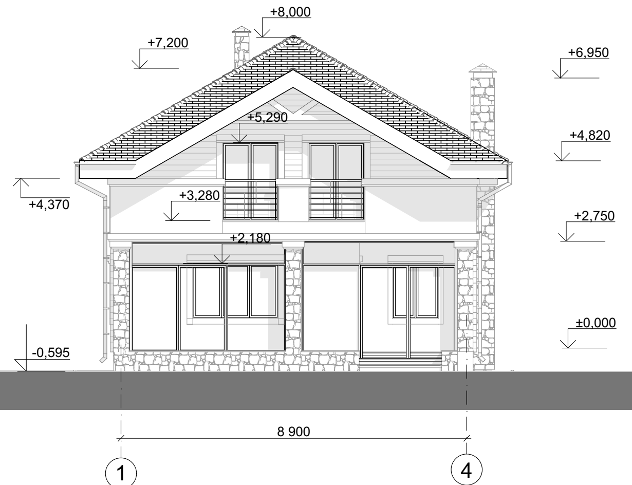
Фасад в осях 1-4
