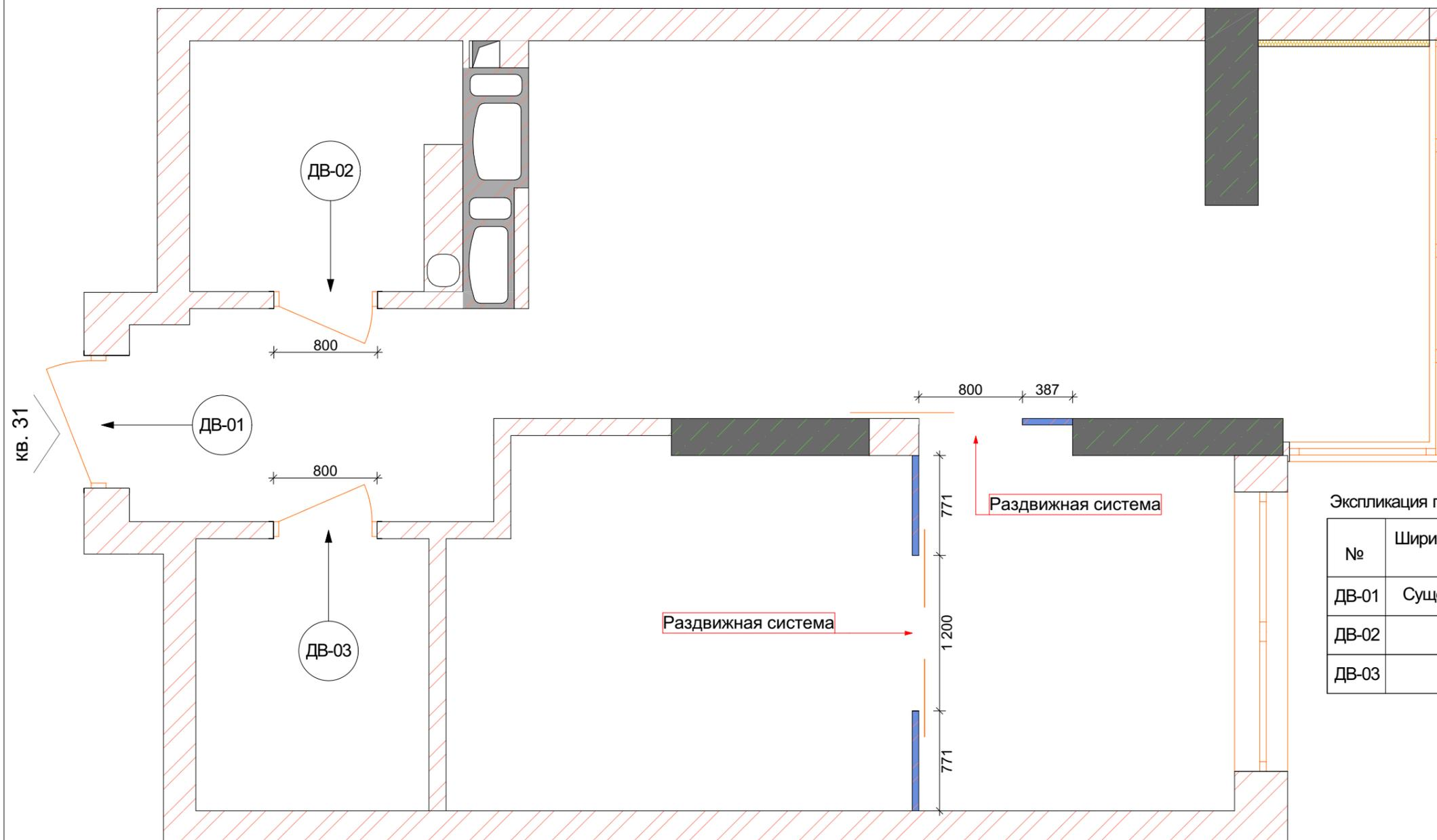
Экспликация проёмов для дверей скрытого монтажа
