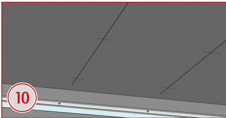
Пробурить по одному отверстию на пересечении разметки для крепления виброподвесов *VibroHolder™ C* диаметром 8мм на глубину 50мм.
