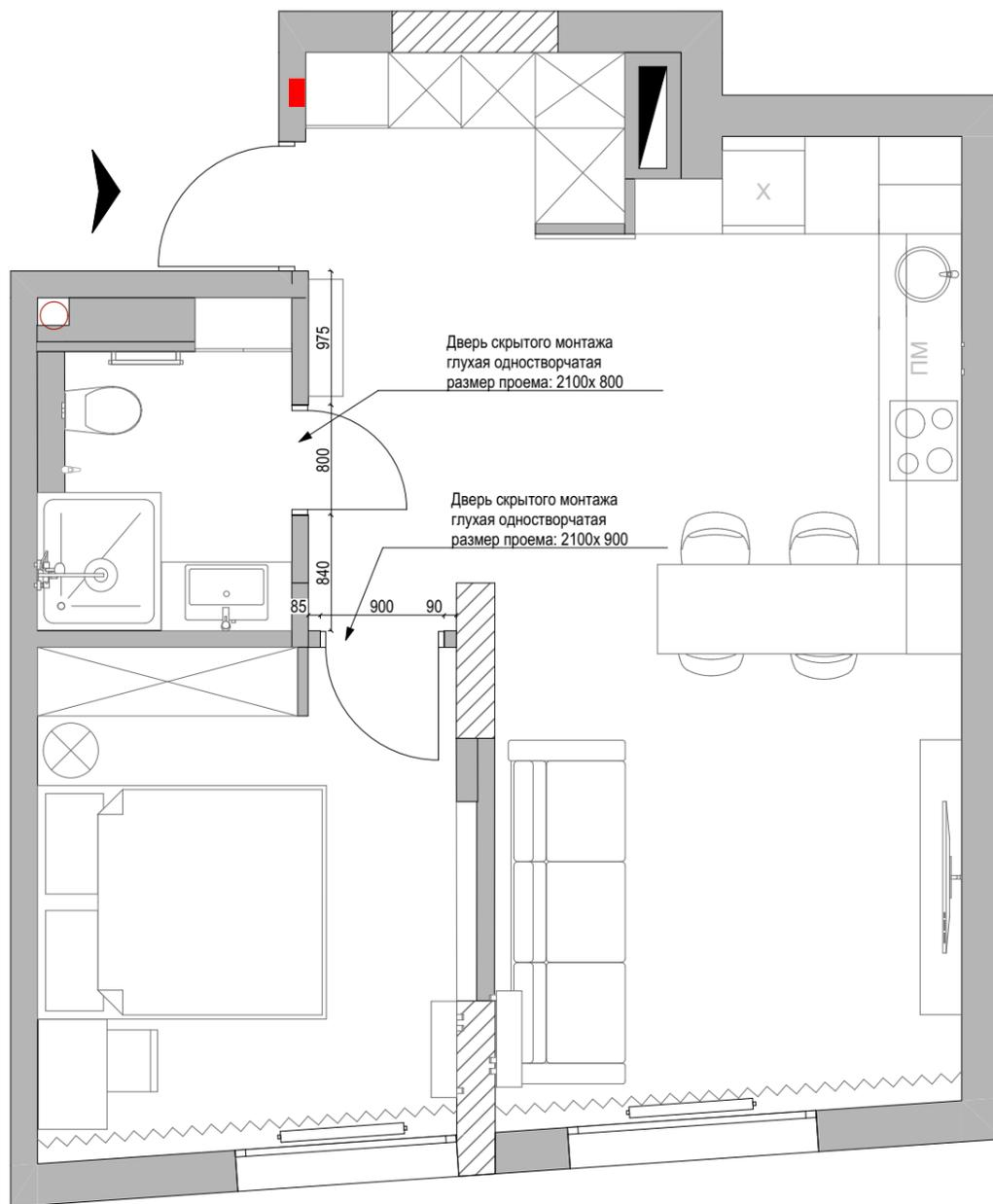
Принцип монтажа дверей скрытого монтажа
