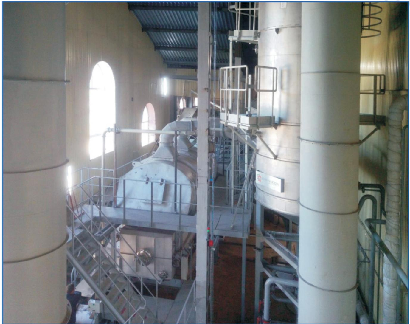
В 2019 году САХАВТОМАТ произвел реконструкцию Жомосушильного отделения на Олымском сахарном заводе. Была произведена замена линии жомосушки с монтажом нового трехходового барабана фирмы Дон-Деталь.
