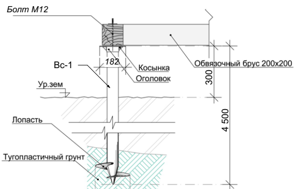
Вузол кріплення бруса 200x200 до свай
