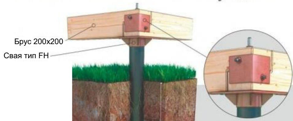
Вузол 2 (підрізка бруса на з'єднанні)
