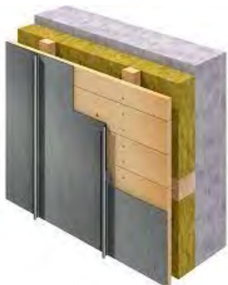
Схематичний вузол влаштування фальцу по фасаді
