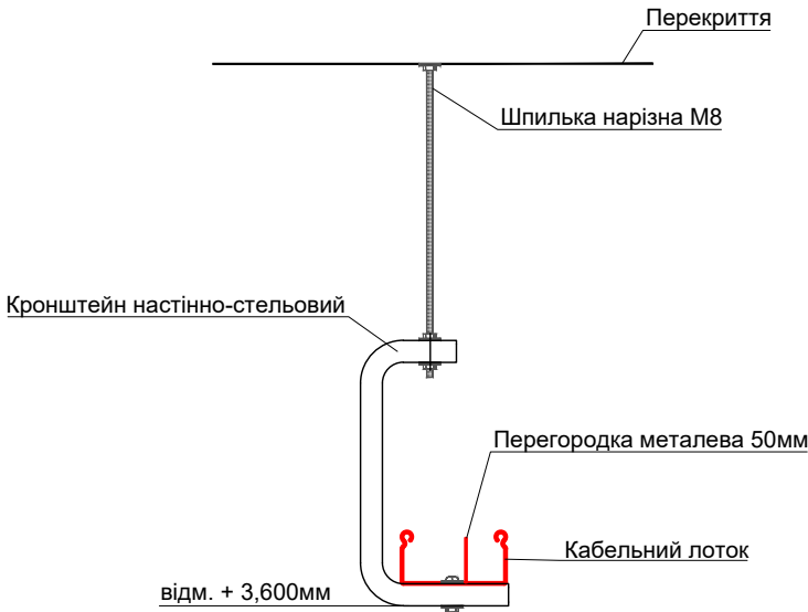
Типовий вузол кріплення лотка 50x100 мм
