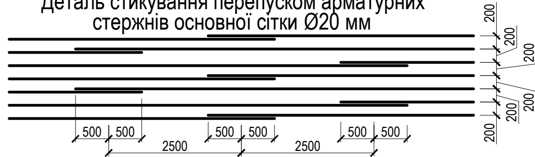
Деталь стикування перепуском арматурних стержнів основної сітки Ø25 мм
