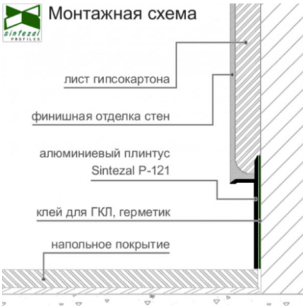
Скритий алюмінієвий плінтус тіньового шву на підлозі Sinteza P-121т(15), H=15mm
