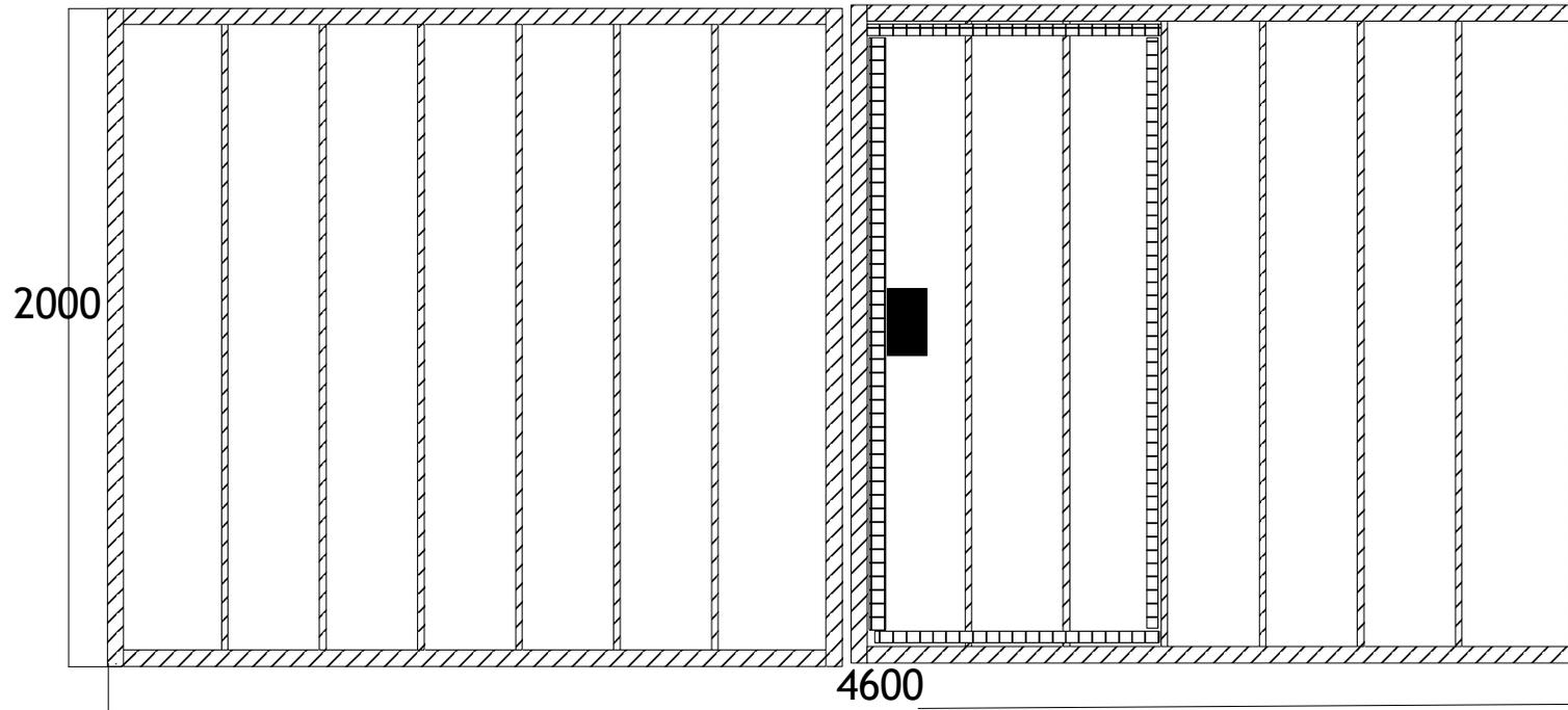
\*Размеры ориентировочные. Ширину нужно уточнить (+-100мм) с учетом закладных, поскольку столбы уже есть.
