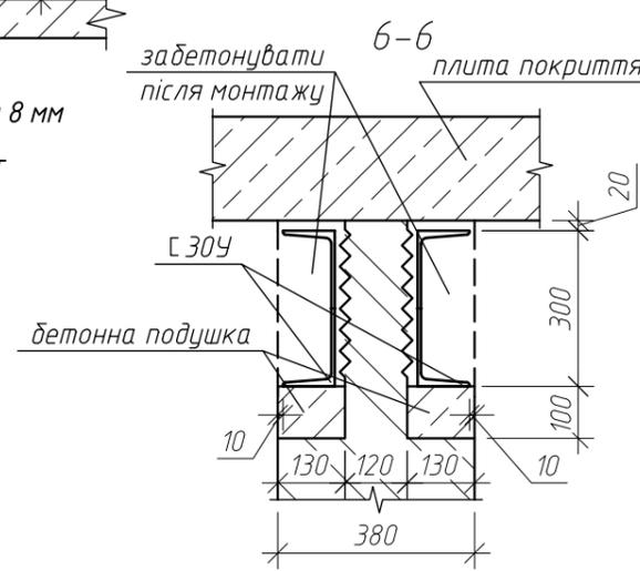
1. Катети зварних швів 6 мм. При зварюванні деталей з товщинами 8 мм та більше катет швів - 8 мм.
