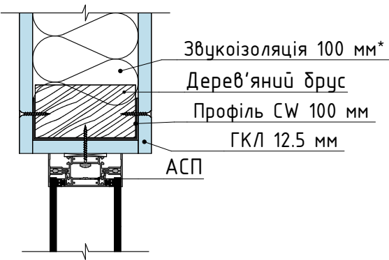
Типовий вузол посилення ГК короба брусом для монтажу АСП
