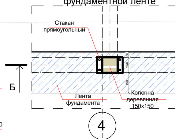
Узел 7 Крепление стоек деревянных к фундаментной ленте
