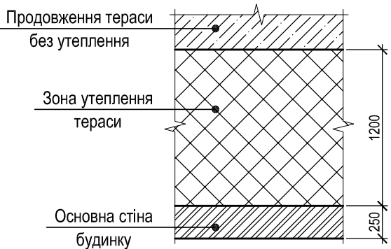
Принципова схема утеплення зони тераси
