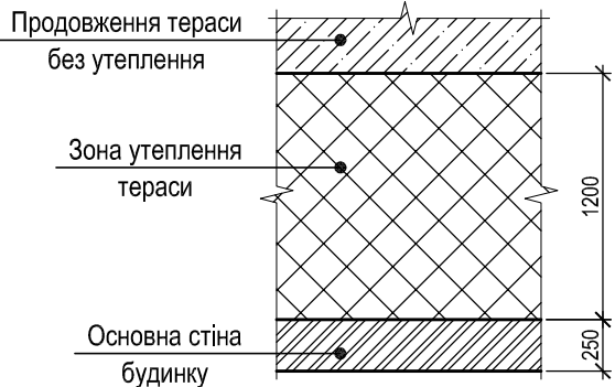
Принципова схема утеплення зони тераси (Вид зверху)
