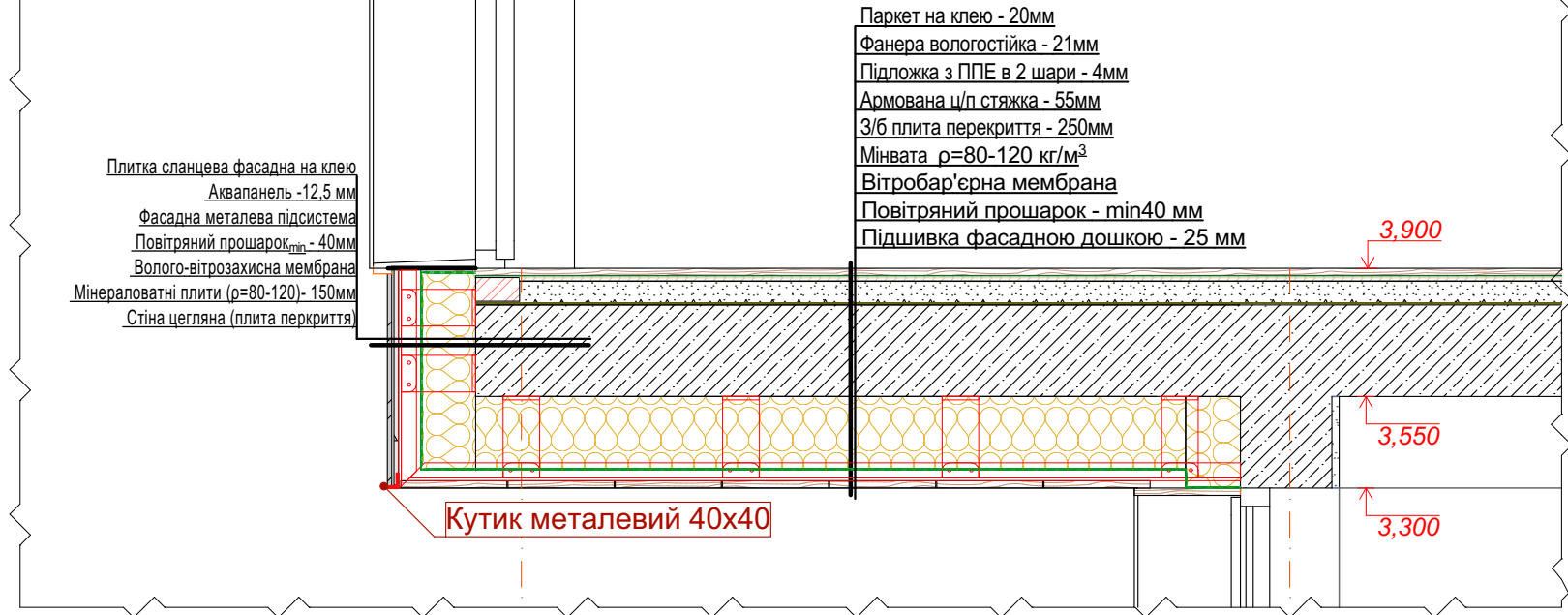
В4. Вузол підшивки консолі у вісях 4-6/А-Б
