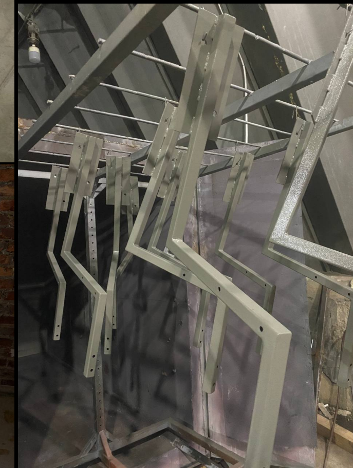
Виготовлення та монтаж металевих огорожень і поручнів сходових клітин, вул.Драгоманова, 31-з у Дарницькому районі м.Києва
